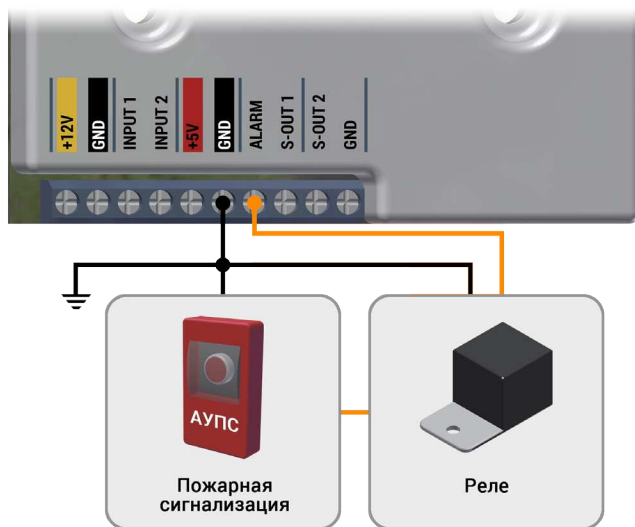
Рисунок 21 - Подключение АУПС к турникету.
