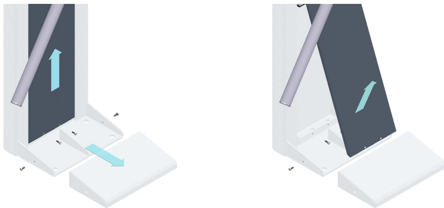
Рисунок 26 – Демонтаж центрального кожуха турникета.
