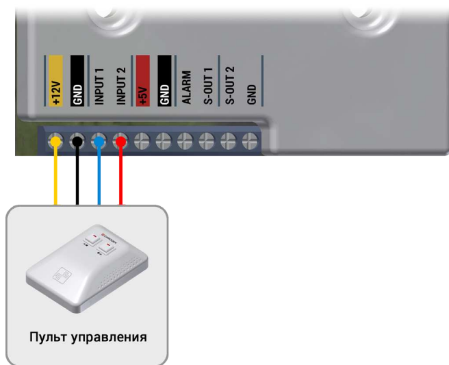
Рисунок 18 - Подключение ПДУ к турникету.
